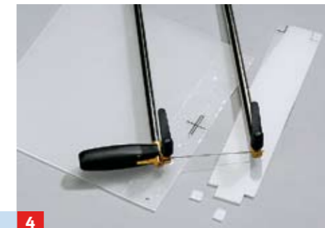
4 3-mm-Acrylglasplatten für Lampenschirm (270 x 270 mm) und Fassungsträger (60 x 300 mm) zuschneiden und einpassen
