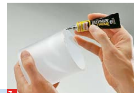
7 Auf den Rand des Acrylglasrohres tragen Sie nun flexiblen Kleber (der Holzschafft schwindet/quillt) auf und kleben ...
