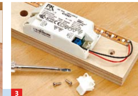
3 LED-Trafo auf der Montageplatte verschrauben und elektrisch polrichtig mit der LED-Leiste verbinden
