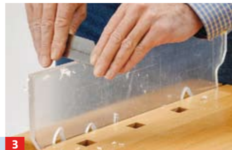
3 Über die polierte Unterseite kann später das Licht besser eindringen. Unterseite zunächst mit einer Abziehklinge glätten
