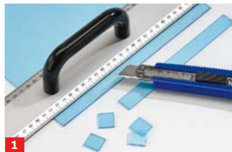
1 Damit die drei Millimeter starken PLEXIGLAS® Radiant-Platten in den verwendeten Steckecken halten, kleine Zulagen ...
