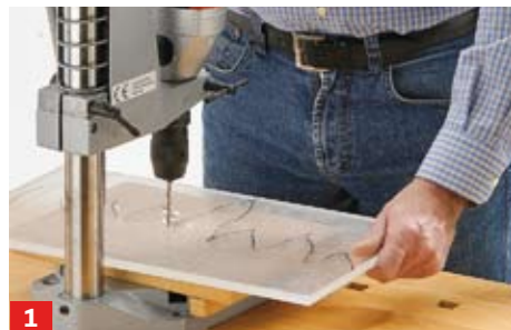
1 Feuerkontur auf dem PLEXIGLAS® mit wasserfestem Stift anzeichnen, Eckstellen mit kleinem Durchmesser vorbohren
