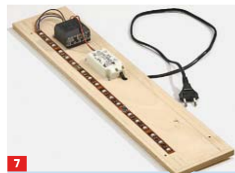
4 Die Halteplatte hat später nach unten etwas Luft zur Grundplatte, damit die Anschlussleitung zu den LED Platz findet
