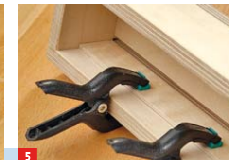
5 Oberhalb des Halteschlitzes wird im Inneren des Kastens eine Aufdoppelung eingeklebt – sie hält später das PLEXIGLAS®
