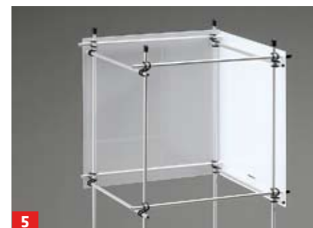
5 Ermitteln Sie die Bohrpunkte im PLEXIGLAS® für die Steckverbindung und bohren dort mit einem 6-mm-Bohrer durch
