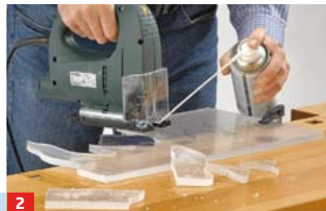
2 Kontur mit Stichsäge und Kurvensägeblatt ausschneiden. Dabei mit geringem Vorschub arbeiten und mit Luft kühlen
