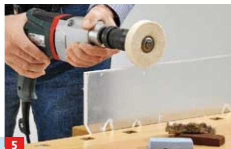
5 Dann mit einer Filzscheibe und Polierpaste (als Set im Shop erhältlich) auf Hochglanz polieren
