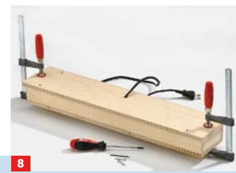
5 Grundplatte für die Verschraubung mit dem Korpus vorbereiten. Dazu Montage-löcher bohren und senken
