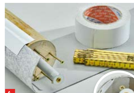
4 Als Schalung wickeln Sie ein Reststück PVC-Boden 50 mm hoch um den Schaft, ...
