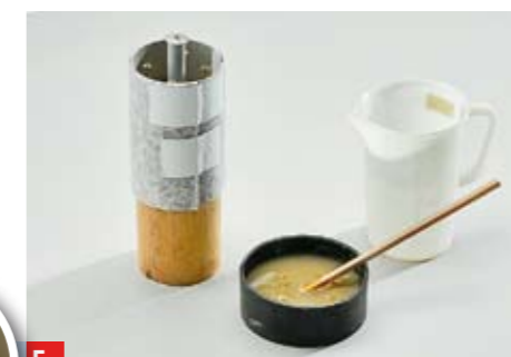
5 ... innen überdeckt ein Klebestreifen den ungleichen Materialstoß. Beton anmischen, einfüllen und verdichten
