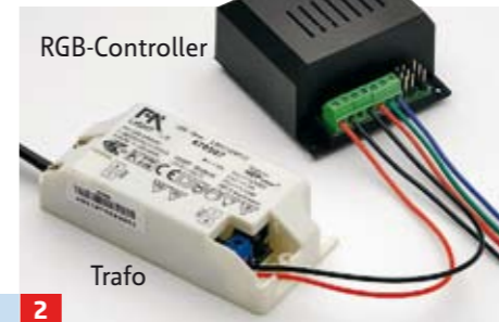
2 Ein Trafo sorgt für die richtige Spannung, der Kaminfeuer-Effekt wird mit einem Steuergerät (RGB-Controller) erzeugt
