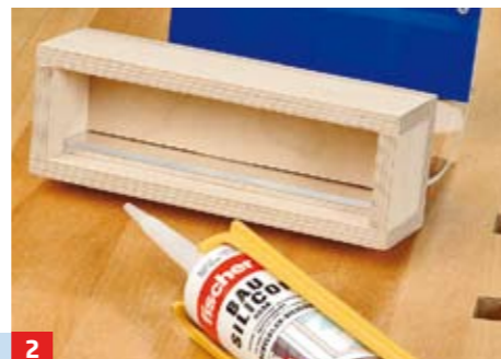
2 Der im Lichtkasten liegende Teil der PLEXIGLAS® Platte wird mit Silikon auf der Multiplex-Aufdoppelung verklebt
