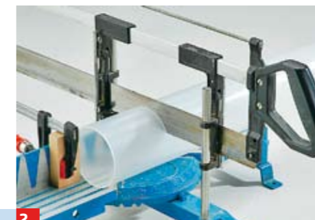
2 Teilen Sie ein mattiertes Acrylglasrohr in 100 mm hohe „Lampenschirme“. Vorsichtig sägen, sonst drohen Materialrisse!
