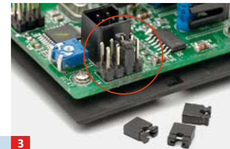
3 Steckbrücken – sogenannte Jumper – ermöglichen die Vorwahl verschiedener Farbwechsel-Programme im Steuergerät
