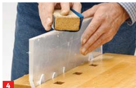
4 Danach die Kante mit Schleifpapier bearbeiten. Dabei mit 300er bis 600er Körnung mit Schleifklotz nass schleifen
