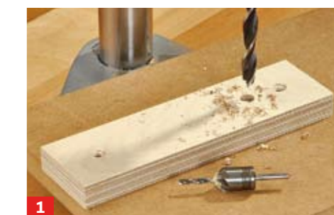
1 Bohrung für die spätere Führung des Netzkabels einbringen. Montagelöcher bohren und senken
