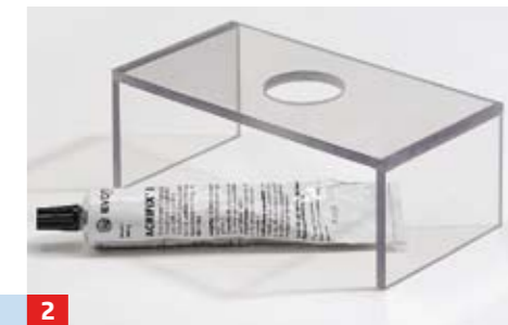
2 Die Teile des Lampenfußes ebenfalls mit Lampenfuß. Nach Zuschnitt Bohrung für die Fassung einbringen, Material dabei fixieren
