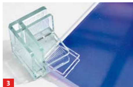
3 Dabei darauf achten, dass die Ecken auf der nicht beschichteten, unfolierten Seite der Platten verklebt werden
