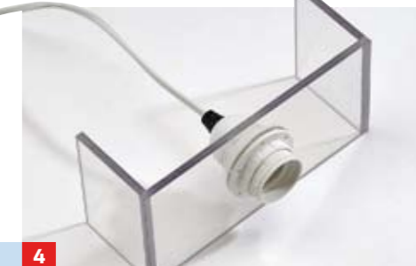
4 ... Fassung mit den beiliegenden Schraubringen in den PLEXIGLAS® Lampenfuß montieren
