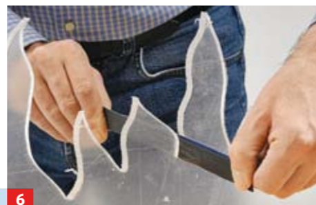
6 Die Feuerkontur an schlecht erreichbaren Stellen mit zu einem Streifen gefaltetem Schleifpapier von Sägeriefen befreien
