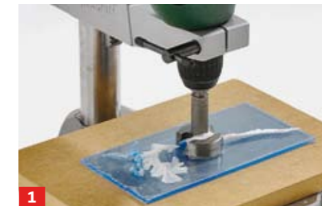
1 Aus 6 mm starkem PLEXIGLAS® XT besteht der Lampenfuß. Nach Zuschnitt Bohrung für die Fassung einbringen, Material dabei fixieren
