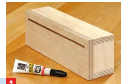
4 Vorbereitete Frontplatte ebenfalls mit PU-Klebstoff aufkleben, bis zur Aushärtung des Klebers fixieren
