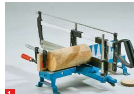
1 Von einem Zaunpfahl (Ø 90 mm) sägen Sie 200 mm lange Stücke. Ein Anschlag aus Restholz garantiert gleich lange Teile
